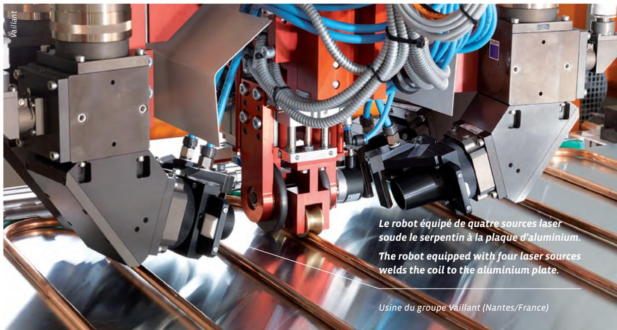
*Le robot équipé de quatre sources laser soude le serpentin à la plaque d'aluminium.
