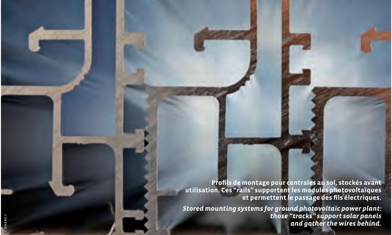
Profils de montage pour centrales au sol, stockés avant utilisation. Ces "rails" supportent les modules photovoltaïques et permettent le passage des fils électriques.
