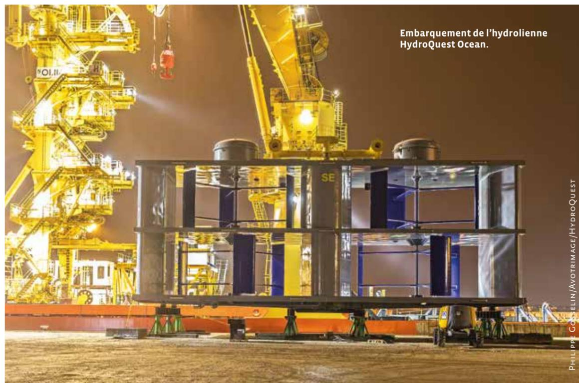
Embarquement de l'hydrolienne HydroQuest Ocean.
