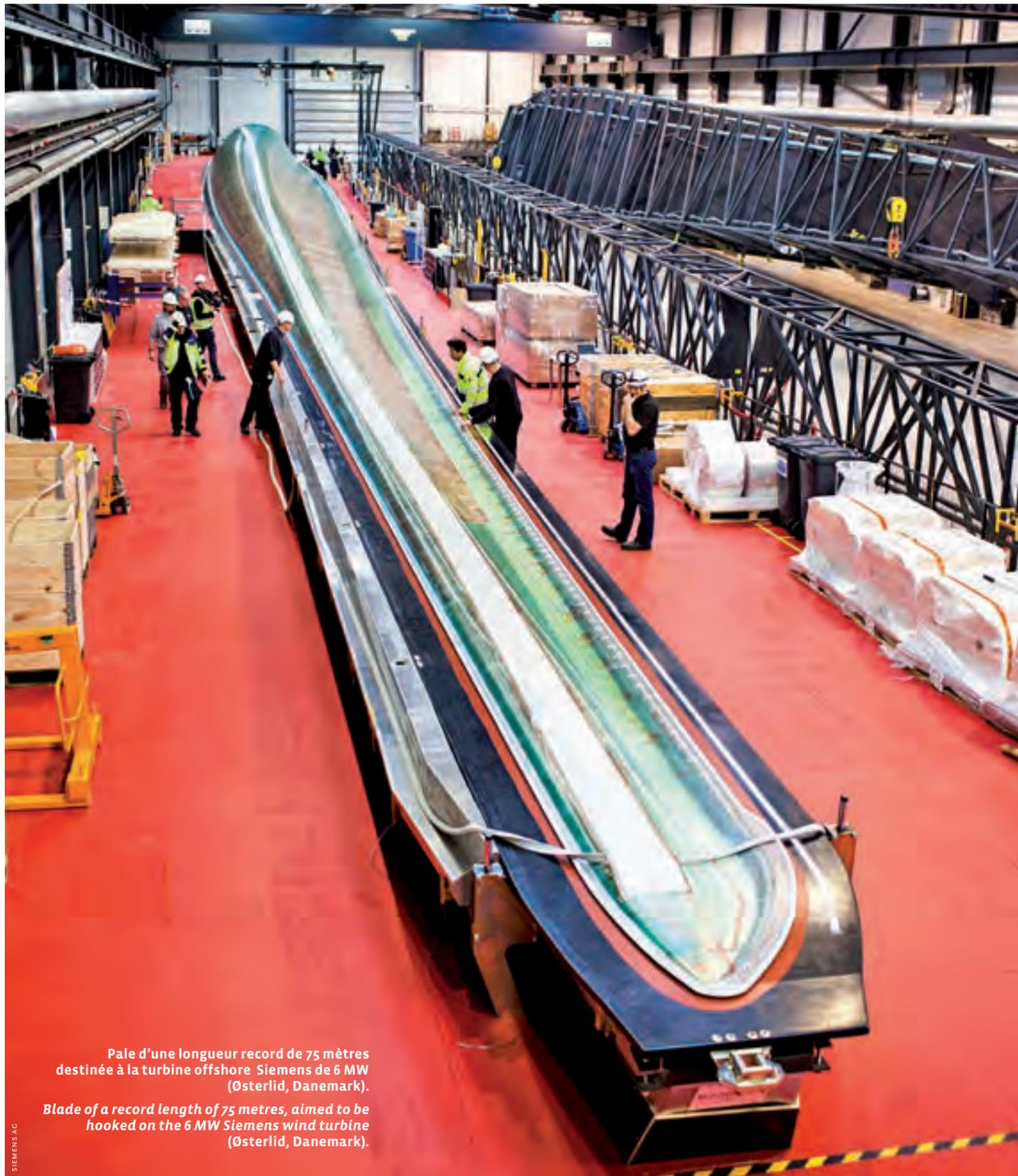
Pale d'une longueur record de 75 mètres destinée à la turbine offshore Siemens de 6 MW (Østerlid, Danemark).
