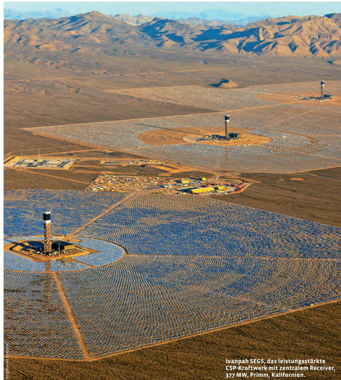
Ivanpah SEGS, das leistungsstärkste CSP-Kraftwerk mit zentralem Receiver, 377 MW, Primm, Kalifornien.
