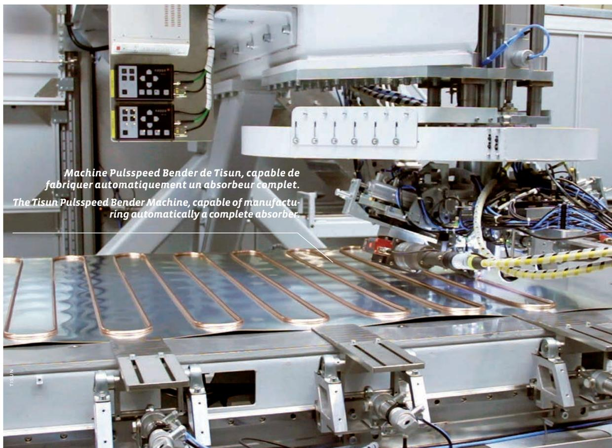
*Machine Pulsspeed Bender de Tisun, capable de fabriquer automatiquement un absorbeur complet.*
